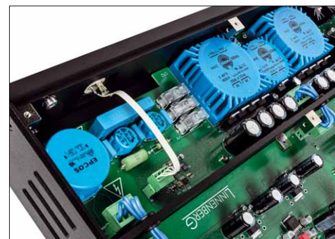
Drei Trafos besorgen die Stromversorgung, links im Bild das aufwendige Netzfilter
